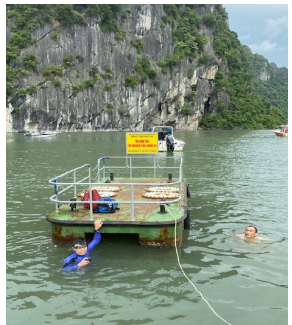
Hình 1. Hệ thống Đài trạm tại Viện Khoa học vật liệu (a) và mô hình tàu thử nghiệm lớp phủ chống ăn mòn và hà hà trong nước biển (b).
