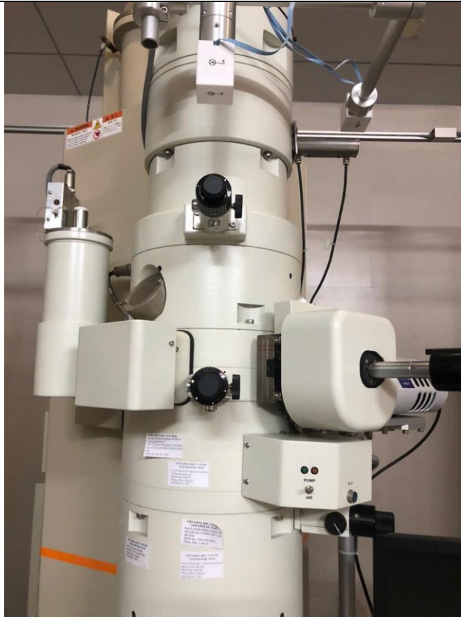
Bơm SIP cho thiết bị kính hiển vi điện tử truyền qua
